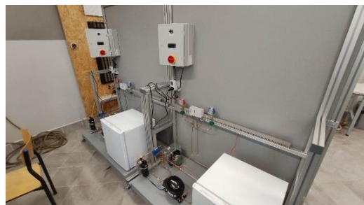
Zdjęcie 10. Zakup sprzętu do Pracowni chłodnictwa w CKZ w Bażanowicach – stanowisko demonstracyjne – pompa ciepła
